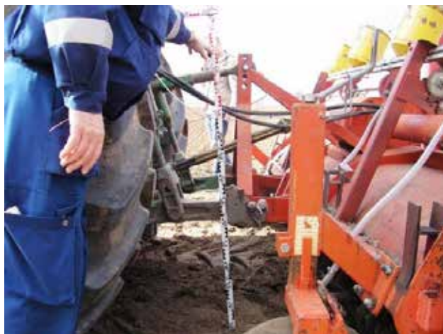
A traktor és a bakhátkészítő munkagép közötti veszélyes tér
