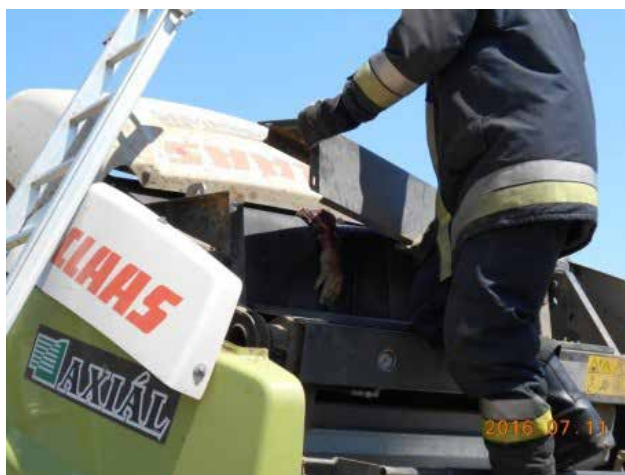
A bálázógép behúztta a munkavállalót és a karját leszakította.
