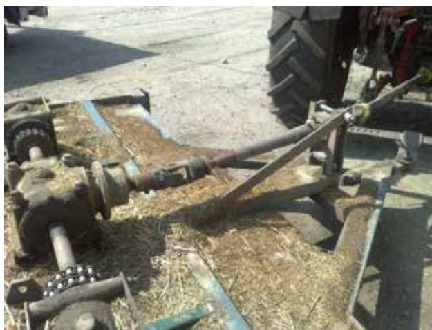
Traktor kardántengelye – védőburkolat nélkül
