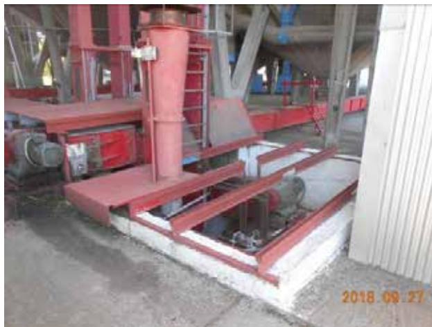
Be- és leesés veszély a terményfelhordó rendszerénél
