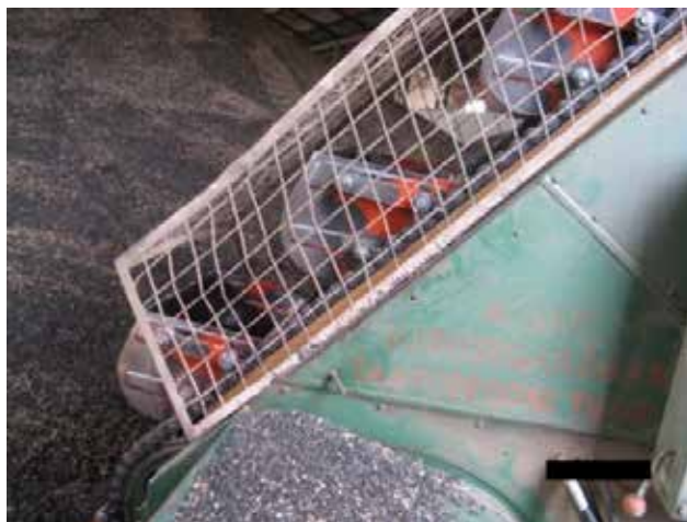
Serleges anyagmozgató gép védőrácscsal ellátva.
