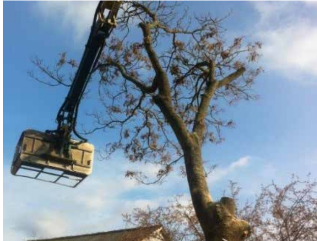
A hidraulikus karos, kosaras személyemelő kosara vízszintes helyzetbe csapódott
